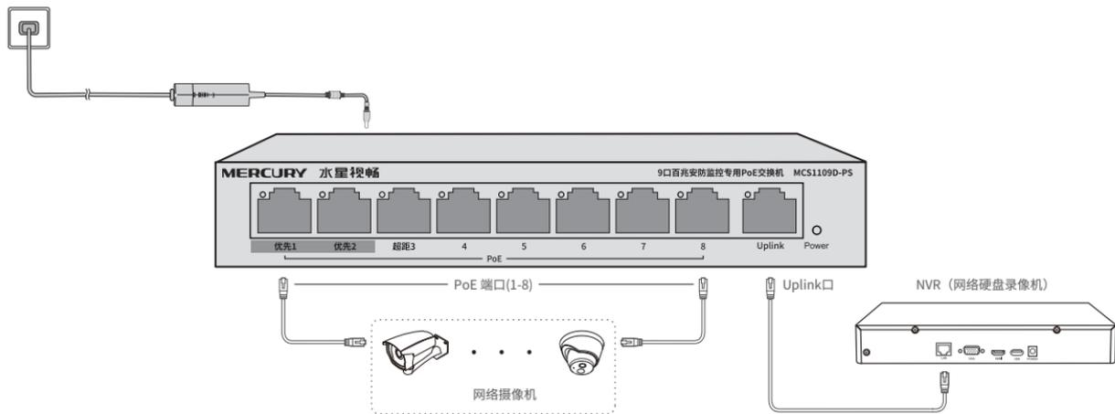
提示：1、2端口为优先保障口，可将重要级别更高的监控设备接入1、2口，确保监控数据优先传输。
